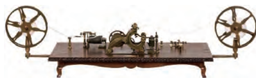
【図1】「ペリー提督献上のエンボッシング・モールス電信機」B機、奥行39.5×横97.5×高さ33.0 cm（外箱寸）、嘉永7年献上（6101-001-1）
