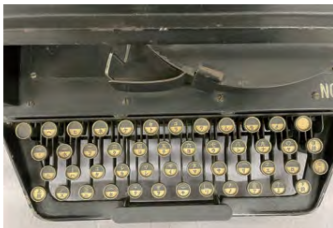
【図32】キーボード部分（2列目：ホフクコチヨウンナヤ）
