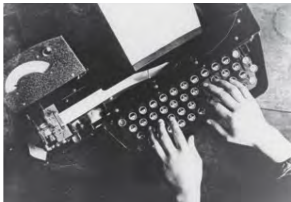
【図1】「テープ式和文印刷機打鍵」〔JBC-0046〕
