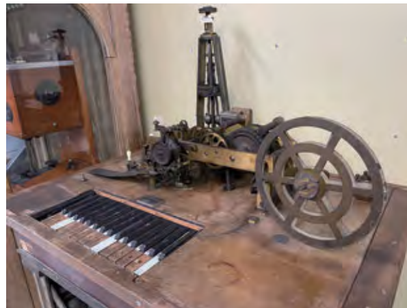
【図22】「ヒューズ印刷電信機」年代不明、Siemens & Halske社製(ドイツ)[6101-枝番なし]
