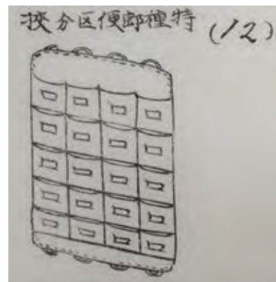
【図6】「特種郵便区分挟」略図（「野戦高等郵便部報告原稿」第三編より）
