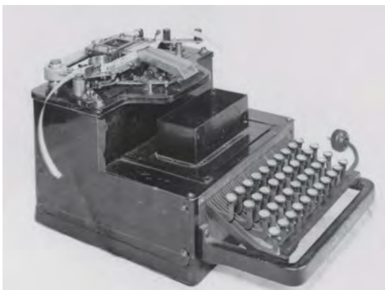
【図30】「クライン・シュミット甲種鍵盤和文鑽孔機」1936年、 Morkrum-kleinschmid社製（アメリカ）、〔JBC-0027-0〕
