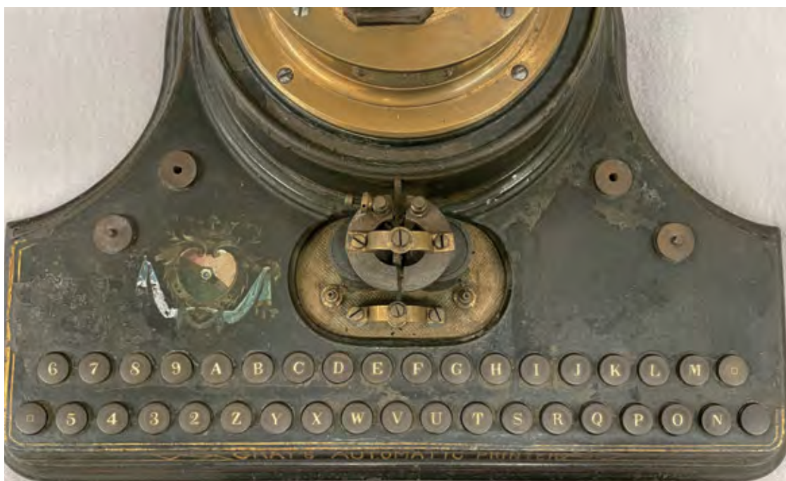
【図19】 キーボード配列は、ABC順。上段（左から）「6 7 8 9 A B C D E F G H I J K L M □」、下段（左から）「□ 5 4 3 2 Z Y X W V U T S R Q P O N 空欄」、【図22】のヒューズと同じ配列
