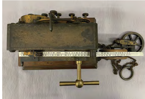
【図27】「自動電信機」（鑽孔式）、1870年推定、Fabrik社製（デンマーク）〔6101-38〕
