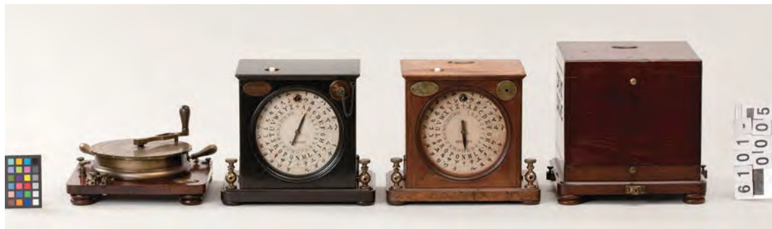
【図3】「ブレゲ指字電信機」1869年、Breguet社製（フランス）、重要文化財、左から送信機、受信機2種、携帯型〔6101-0005〕
