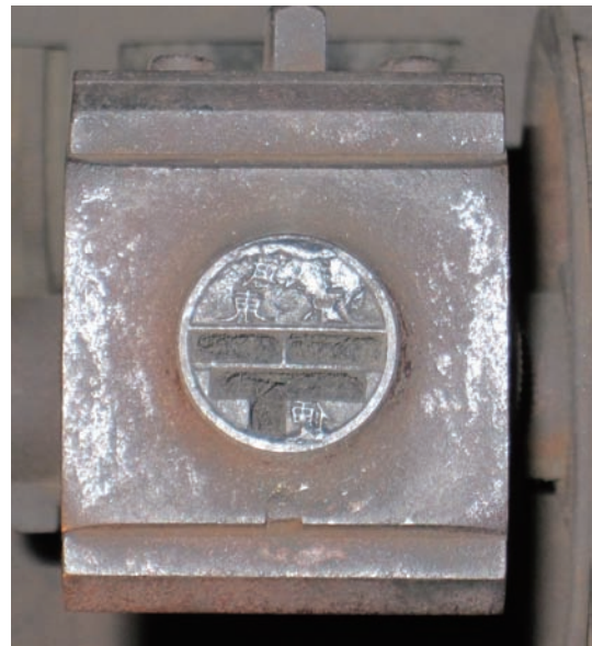
図 5-2 押印ハブ (印顆付) の印顆部分 (縦55×横48×奥行20mm) 印顆直径22mm
