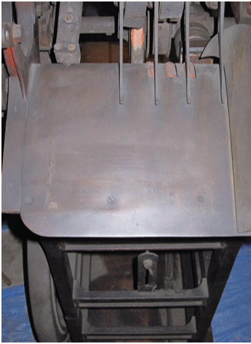
図 4 B-1 後方プレート全体図 (横210×奥行345mm)
