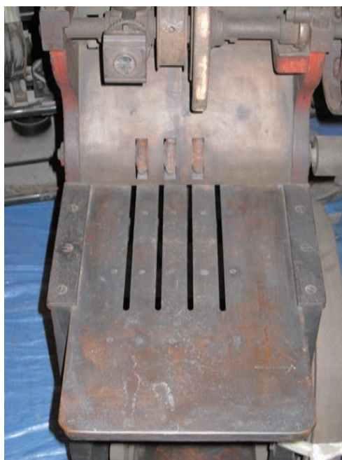
図4A-1 前方プレート全体図 (横285×奥行400mm)
