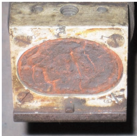
図6-2 押印ハブ (印顆無) (楕円部分：縦30×横47mm)
