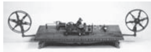
図8 ペリー提督献上のエンボッシング・モールス電信機
